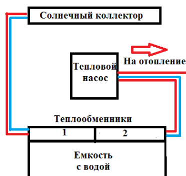
Рисунок 1. Схема системы отопления с помощью льда
